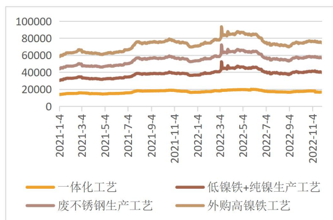
图 2.55：304 冷轧不锈钢分工艺生产成本（元/吨）
